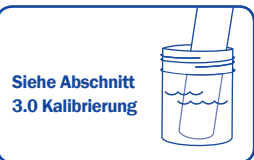
Die Spitze des Messfühlers muss in der Schutzkappe mit KCl-Aufbewahrungslösung bedeckt sein
